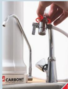
➤ Der Filter wird auf den Kopf gestellt, der Hebel am Umlenkventil in die waagerechte Position gebracht (lenkt Wasser durch den Filter) und der Wasserhahn aufgedreht: Wasser fließt durch den Filter, die Luft im Inneren des Gehäuses wird restlos verdrängt. Mit dem Regler am Ventil kann der Wasserdurchfluss gesteuert werden.
